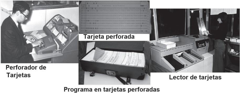
Figura 28. La secuencia gráfica muestra un equipo perforador de tarjetas, una tarjeta perforada, un programa transcrito a tarjetas y situadas en su caja lista para colocarlas en el lector y finalmente un lector de tarjetas que leía el contenido de cada tarjeta y lo transmitía a la computadora.
